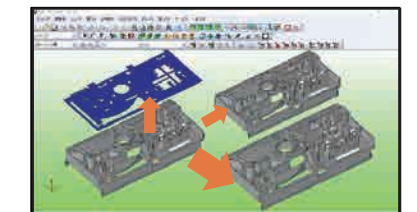
投影平面・収縮機能 投影平面作成やスケール変更が出来ます。
