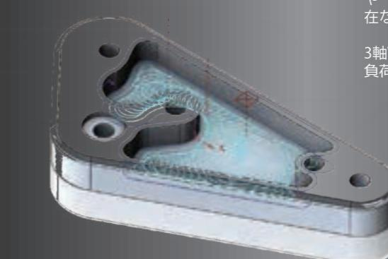
ポケットイン／アウト：切削量の多い加工に適したパターンです。安定したダウンカットを維持するツールパス作成と、Z方向の切れ込みには各段ヘルカル进入することで下穴を不要としています。
