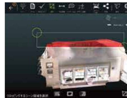
点群データの部分削除や点群集合比率に合わせた一括削除が可能
